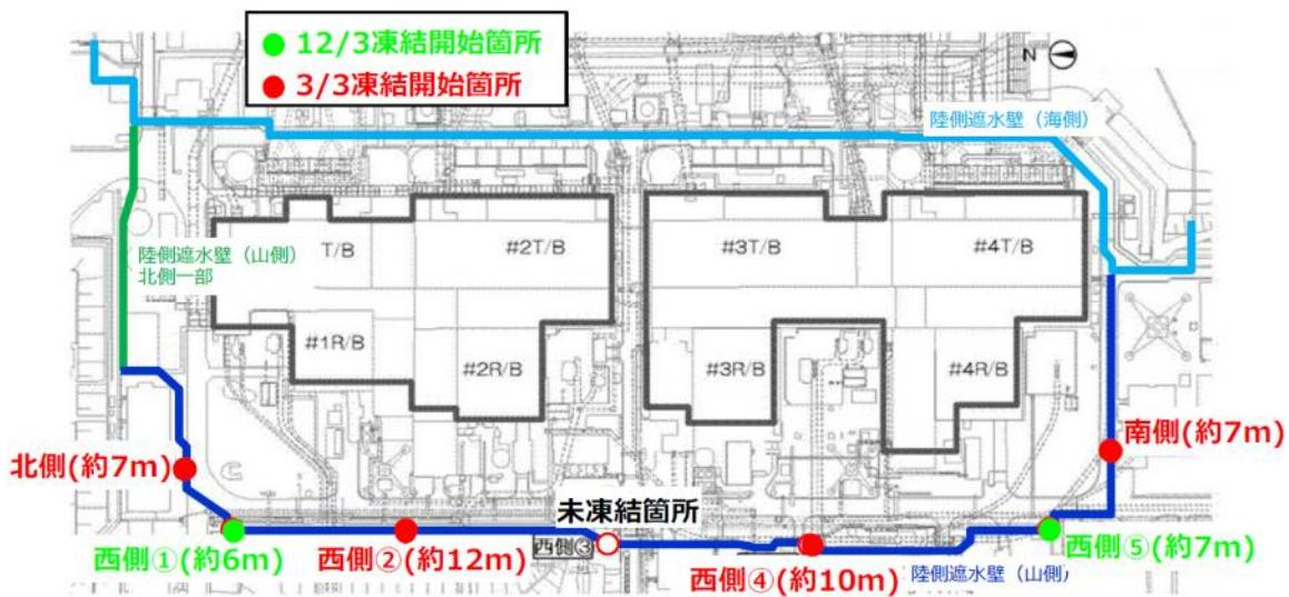
図 3-2 陸側遮水壁（山側）の一部閉合箇所
