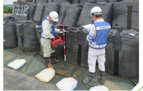
仮置場内における空間線量率の測定の様子
