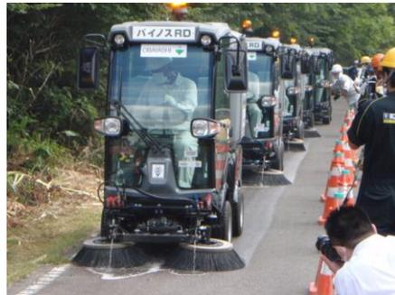
写真2 アスファルト路面の除染
