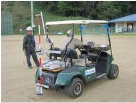
写真1 電動カート式放射線量計測車
