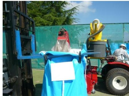
写真2 砂抜き・フレキシブルコンテナ
