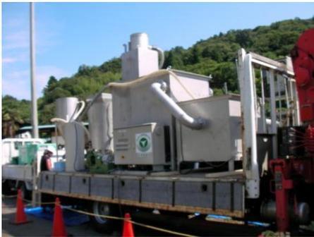
写真1 車載型水処理装置
