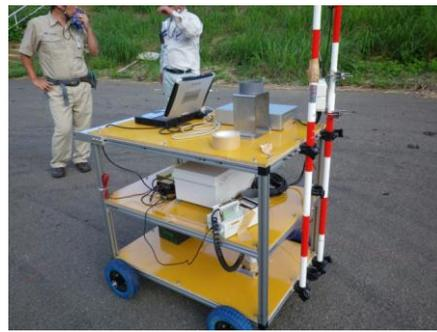
写真2 手押し式放射線量計測車
