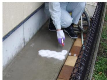
写真4 コンクリート表面への洗剤散布
