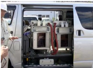
写真1 蒸気洗浄機本体
