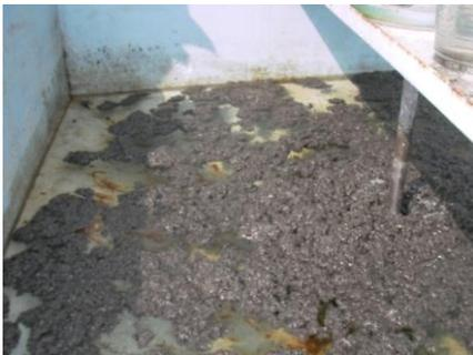
写真3 汚染水の凝集処理
