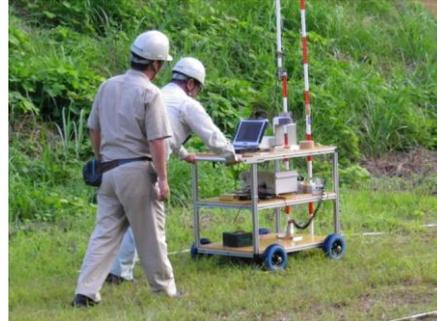
写真4 手押し式放射線量計測
