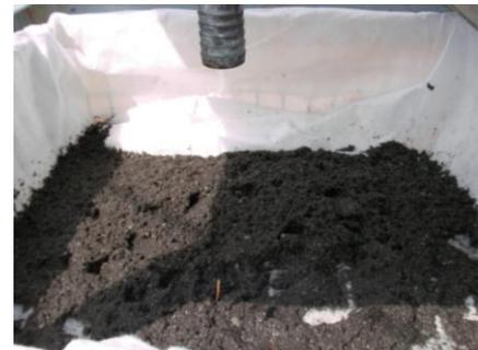
写真4 ろ布に回収された凝集沈殿物
