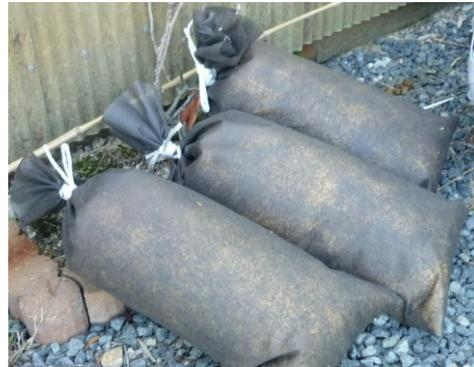
写真4 装置に充填されるモミガラ
