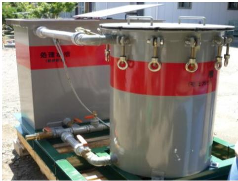
写真3 モミガラ処理装置
