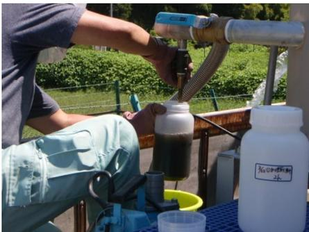
写真3 原水槽の試料採取
