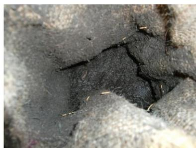
写真4 汚泥（凝集沈殿物）
