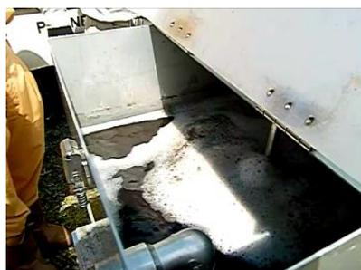
写真3 固液分離装置
