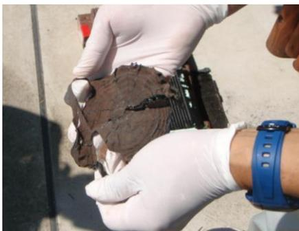
写真1 丸太横断面の剥離した塗膜
