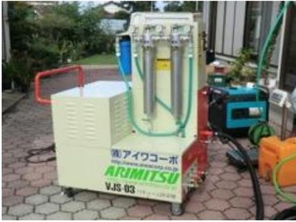
写真1 循環回収型放射能除染機
