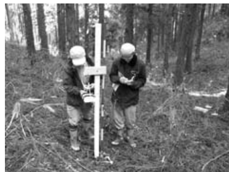
図-9 樹冠方向からの放射線量測定
