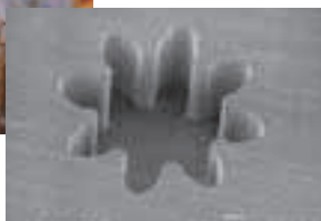
微細放電加工による 金型キャビティ
