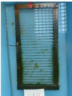
図1 試験に使用した採苗器
