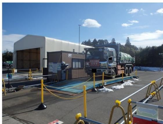
輸送車両の重量測定状況の確認
