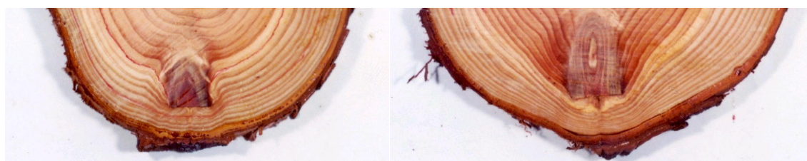
樹脂滲出停止、枝の直径14.6mm 樹脂滲出なし、枝の直径17.8mm 図 - 28 円盤面に現れた残枝なしの枝打ち痕
