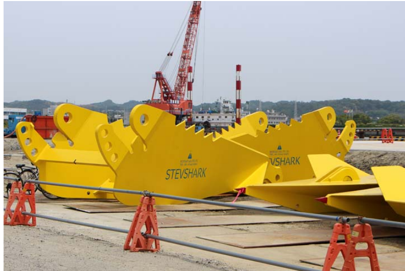
図 2.1-6 福島沖の浮体式洋上風力発電におけるアンカー (出典) 福島洋上風力コンソーシアム
