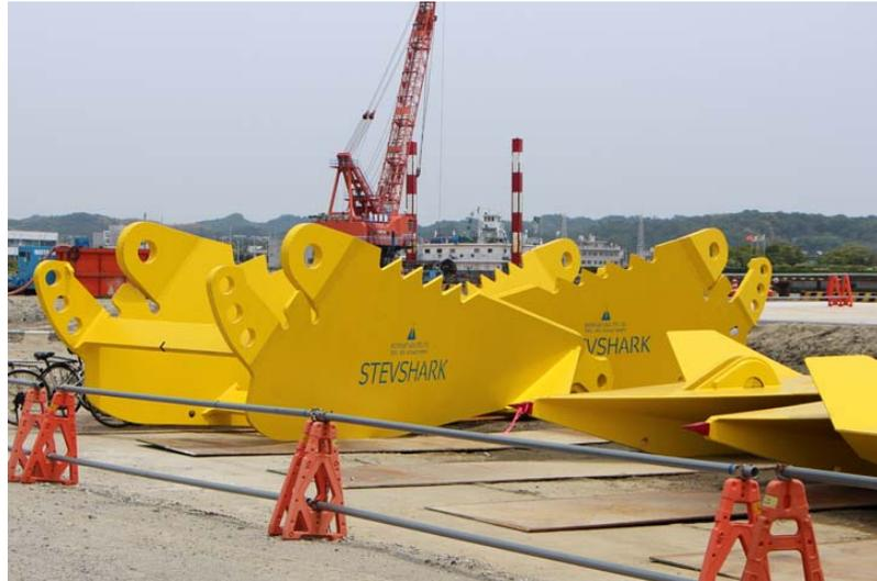
図 2.1-6 福島沖の浮体式洋上風力発電におけるアンカー
