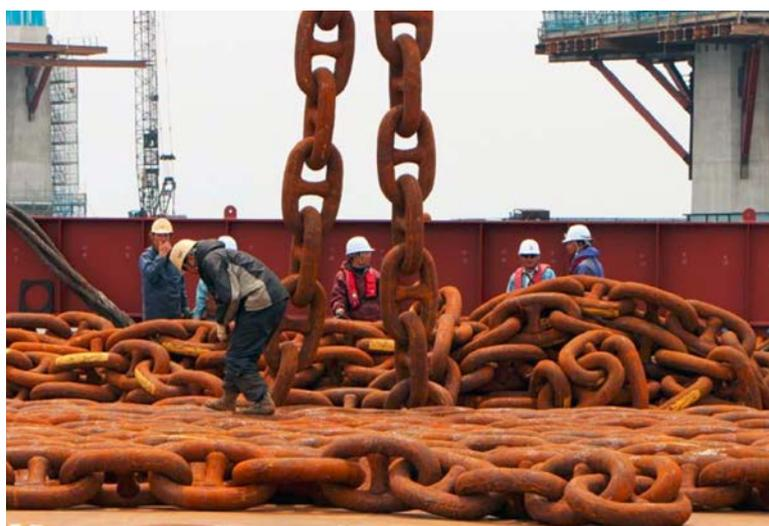
図 2.1-5 福島沖の浮体式洋上風力発電における係留チェーン
