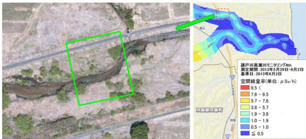
図. 試験場所 (福島県浪江町高瀬川河川敷) 右は従来型検出器で測定された放射線分布マップ
