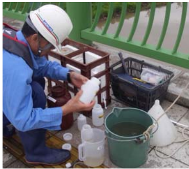
(採水した試料の分取作業)
