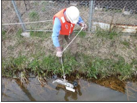
(バンドーン採水器による採水作業)
