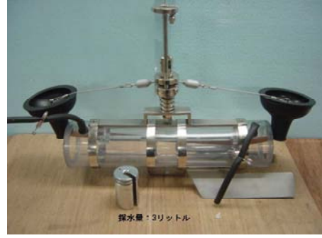
(バンドーン採水器による採水作業)
