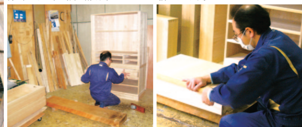
釘を使う場合は、木を細く削って作った木釘を紙一枚も入る隙間がないほど、緻密に組み立て、表面の取っ手以外に金属は使いません。
