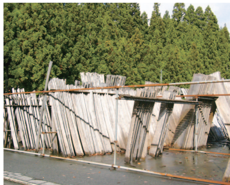
約3年かけて干し、外で雨や風にさらしてシブ抜きをします。
