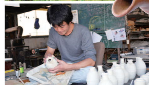
形を整えて乾燥させたものの表面の粗さをとるため、スポンジで丁寧に擦っていきます。
