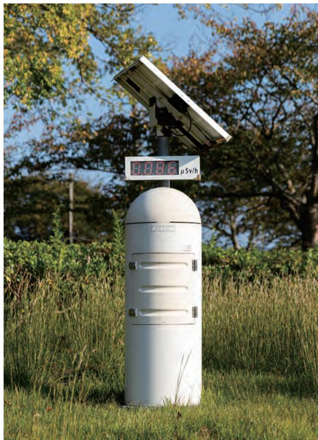
県内に設置された可搬型モニタリングポスト(左)とリアルタイム線量測定システム(右)
