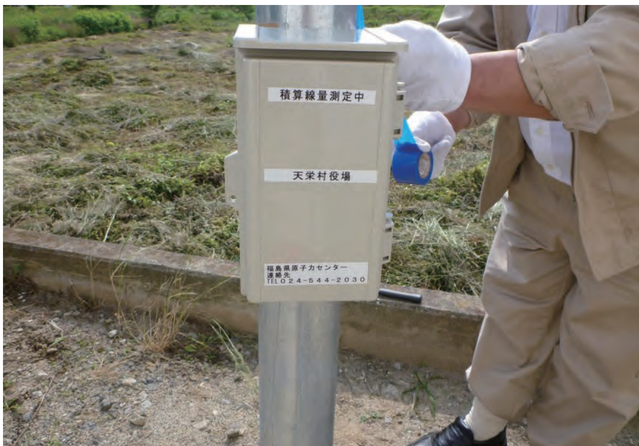
積算線量計(APD代替)の設置状況(2011年6月20日)
