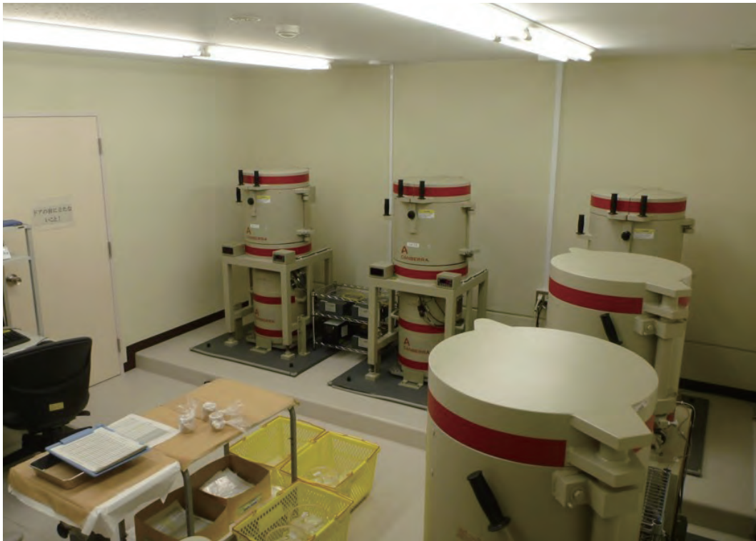
福島支所の車庫に増設した ゲルマニウム半導体検出器
