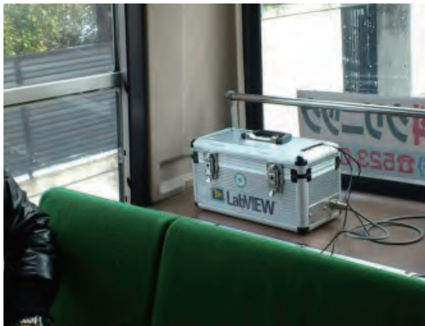
路線バスへのKURAMA-II搭載試験の様子
