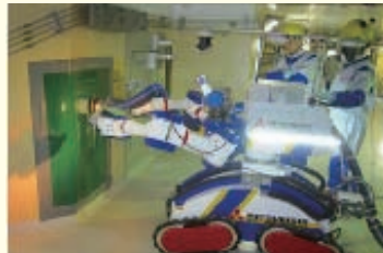
吸引・プラスト除染装置(MHI-MEISTeR) 開発元:三菱重工 本体サイズ:W700mm×D1250mm×H1300mm 重量:約500kg
