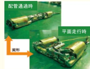
1号格納容器(PCV)内部調査装置(形状変換型ロボット:クロータイプ)
