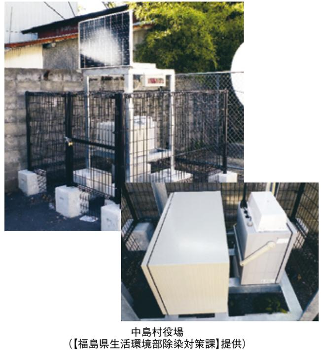
福島第一原子力発電所周辺を含む全県 5km メッシュ（会津地方は 10km メッシュ）毎に可搬型モニタリングポスト 570 台を整備して、精密に放射線量を測定している。原子力規制委員会や福島県のホームページにより、設置場所の放射線量がリアルタイムで表示されている。
