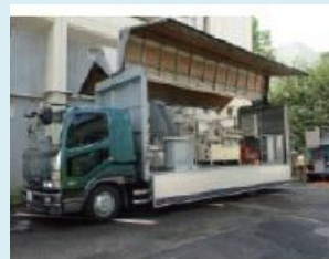
トラックで運ぶことができるモバイル型汚染水浄化装置
