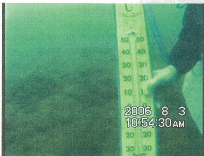
潜水夫による湖粹の水温測定 (水温 約 11℃)
