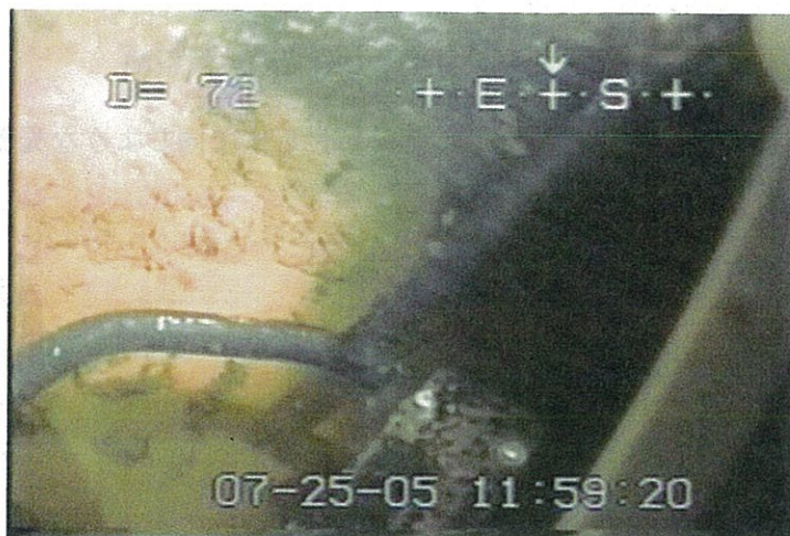
沈降物（フロック）の堆積状況 （水深 7.2 m）
