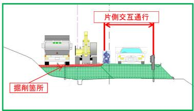
石川方面に向かう車線の幅員を確保しながら、いわき方面に向かう車線を掘削し舗装を行う。
