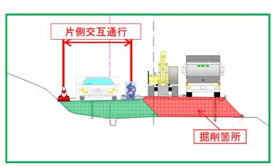
車線を切り替えて、石川方面に向かう車線を掘削し舗装を行う。
