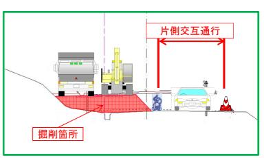
さらに車線を切り替えて、いわき方面に向かう車線を掘削し舗装を行う。
