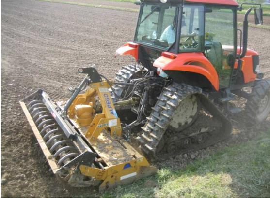
バーチカルハローにより、碎土と整地及び鎮圧を同時に完了させます。鎮圧によりほ場の沈み込みを抑制する効果が期待できます。
