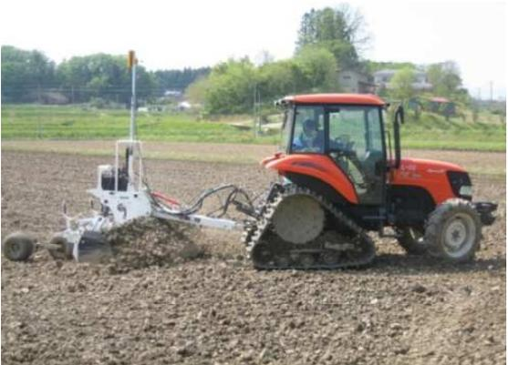
レーザーレベラー (レーザー光線を利用した均平システムを装備したトラクタと作業機による均平) により、精度の高い均平作業を行いほ場を仕上げます。
