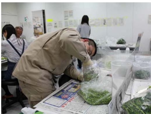
⑥ 隙間ができないよう、容器に試料を詰め込む
