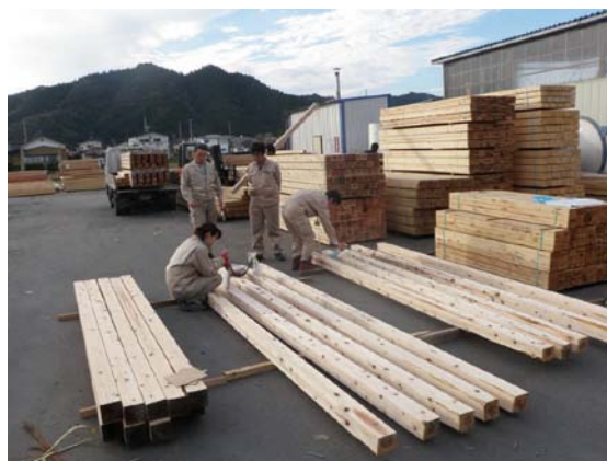
写真 3-7 県産製材品の検査状況
