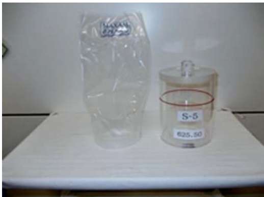
⑤ 汚染防止のため、容器内部にパウチをセットし外側をビニール袋で包む
