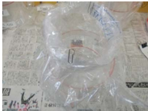
⑤ 汚染防止のため、容器内部にパウチをセットし外側をビニール袋で包む
