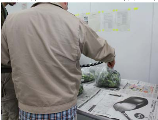
① 試料を調整する前にサーベイメータにより放射能レベルを確認
