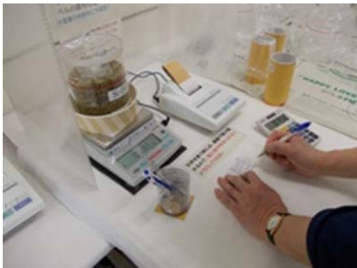
⑦ 電子天秤で試料の重量を測定する
