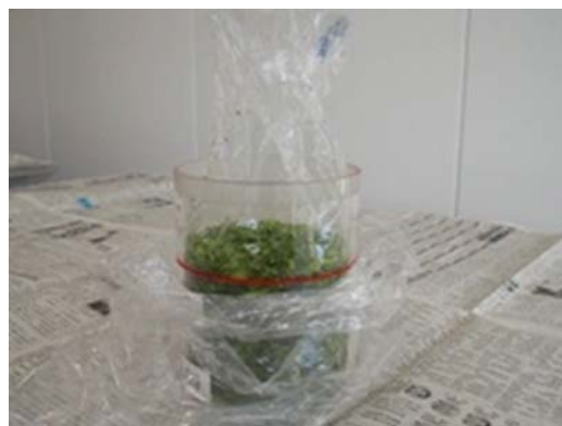
⑤ 汚染防止のため、容器内部にパウチをセットし外側をビニール袋で包む
