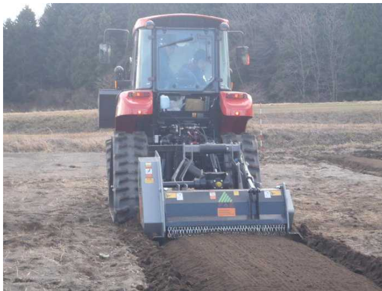
ストーンクラッシャーの作業状況 （けん引式ストーンクラッシャー）
