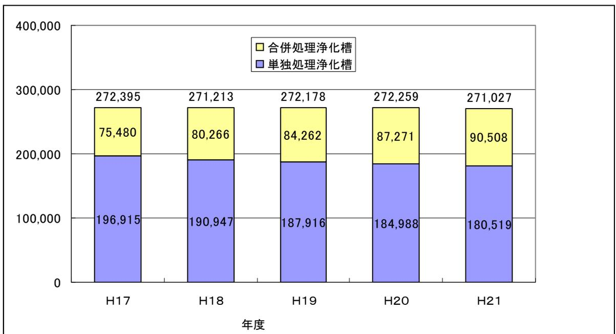
8 **図 3 - 1 1 浄化槽の設置状況の推移**
