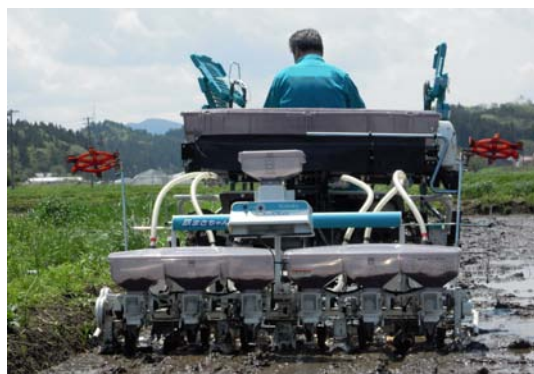
鉄コーティングによる水稲直播栽培 における播種作業
