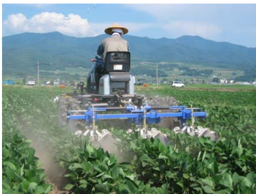
大規模経営に対応した機械化 (大豆管理機による除草作業)
