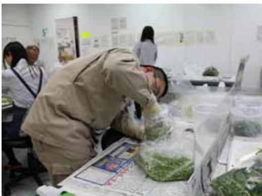
隙間ができないよう、容器に試料を詰め込む
