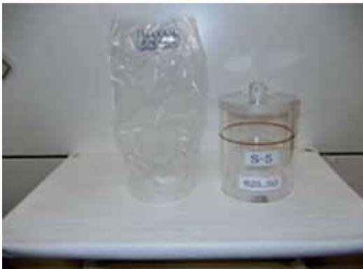
汚染防止のため、容器内部にパウチをセットし外側をビニール袋で包む
