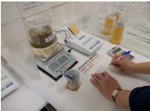
電子天秤で試料の重量を測定する
