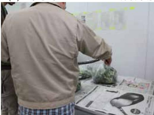
試料を調整する前にサーベイメータにより放射能レベルを確認
